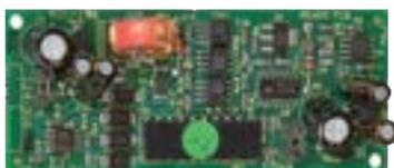
Erweitert die NF 30-A bzw. die NF 50-A um eine galvanisch getrennte RS 485-Schnittstelle. Diese ermöglicht eine Anbindung von bis zu 16 Fernanzeigefeldern vom Typ IDR-2P bzw. Typ 002-450-002 an die BMZ.
