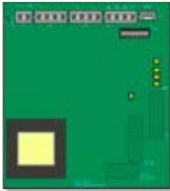
Die 4-fach-Ausgangsplatine erweitert die BMZ um 4 konfigurierbare, leitungsüberwachte Ausgänge nach EN54-13 und 2 konfigurierbare, digitale Eingänge. Bis zu zwei 4-fach-Ausgangsplatinen können in die BMZ eingebaut werden.
