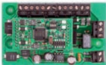
Zur redundanten Ansteuerung eines 9102.0079 RE. Gemäß Forderung aus der DIN 14675 kann mit diesem Interface die BMZ-Schnittstelle als redundanter Übertragungsweg ausgeführt werden. Diese Platine kann in die NF50-A, NF50 bzw. NF50-S eingebaut werden.
