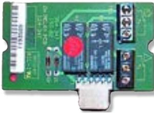
Erweitert die BMZ um 2 potentialfreie Wechsler, die bei Sammelfeuer und Sammelstörung der BMZ automatisch angesteuert werden
