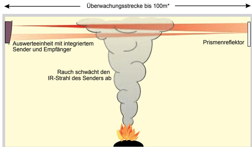
(\*) Für Anwendungen zwischen 70 und 100m steht das Langstrecken-Zubehör-Kit **BEAM-LRK** zur Verfügung.
