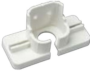
Der Montageadapter wird zur schnellen und sicheren Befestigung von Sockeln der Melderserien OPAL, 700, 800 und ECO 1000 an abgehängte Deckensysteme verwendet. Er erspart den Einsatz spezieller Hohlraumbefestigungen, denn die Befestigungsschrauben des Sockels werden direkt in die Schlitzlöcher des Montageadapters eingedreht. Zusätzliche Vorteile bietet der Montageadapter bei Fixierung der Kabel, starrer/ flexibler Verlegeröhre und Kabelverschraubungen.
