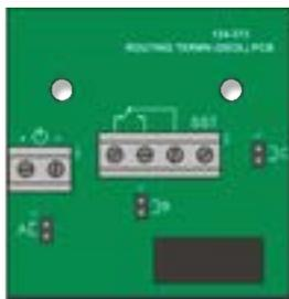
Notwendig bei Verwendung des überwachten Störungsausgangs. Die RTU01-Platine wird als Abschlusselement im Gehäuse der Übertragungseinheit eingebaut.
