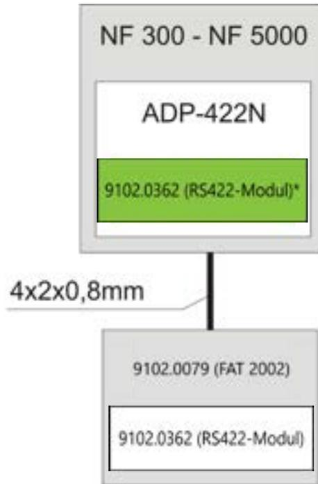
Anbindung FAT 2002 RE (Redundant) an einer NF 300 - NF5000
