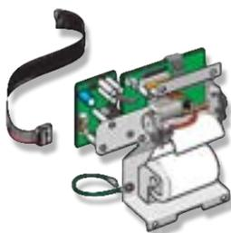
Ermöglicht den Einbau eines 80-Zeichendruckers. Wird über eine interne Druckerschnittstelle angesteuert. Wird mit einer Papierrolle geliefert.
